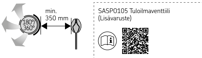
Kuva 10. Tuloilmaventtiilin vähimmäisetäisyys lämpötila-anturiin
