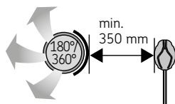
Rysunek 10. Minimalna odległość otworu wentylacyjnego od czujnika.
